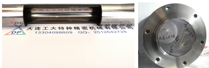
图8 不锈钢管内表面的电化学机械加工效果
