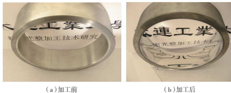
图1 轴承套圈电化学机械光整加工前后表面
